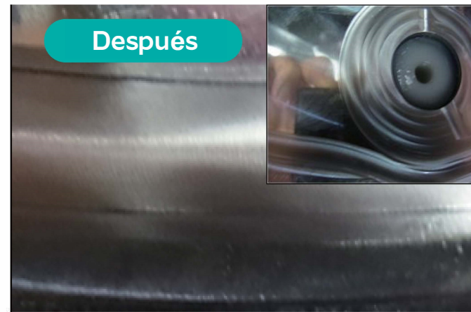
CNC Pulido 41min/pieza de trabajo (reducida en un 46%)
